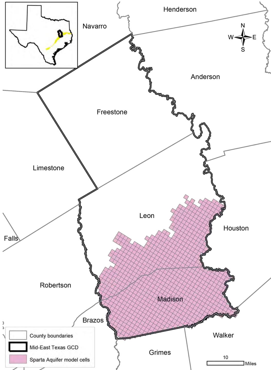
**FIGURE 2: AREA OF THE GROUNDWATER AVAILABILITY MODEL FOR THE SPARTA AQUIFER FROM WHICH THE INFORMATION IN TABLE 2 WAS EXTRACTED. ONLY THE CELLS REPRESENTING THE SPARTA AQUIFER WITHIN THE DISTRICT BOUNDARIES ARE SHOWN.**
